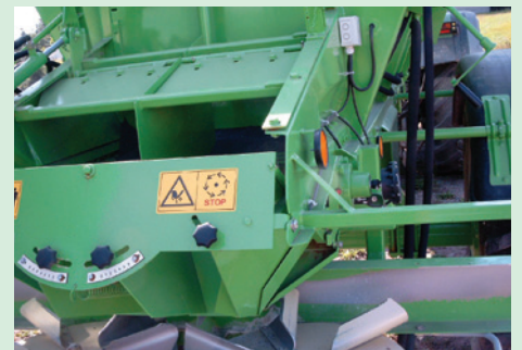
Hydraulisch betätigte Klappe, verhindert Rieselverluste bei Straßenfahrt.
