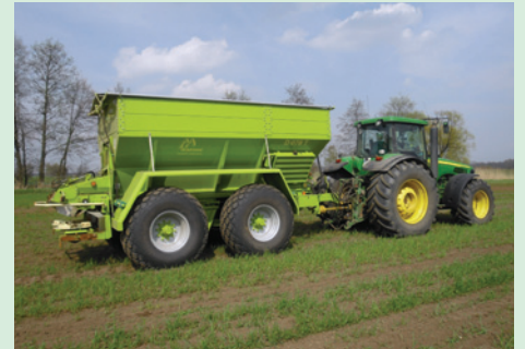
GDK 8.000 T (14m³) mit Bogie-Achse für die Kalkung und Grunddüngung.
