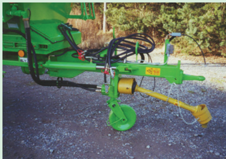
Automatik-Lenkdeichsel, für spurtreues Fahren.
