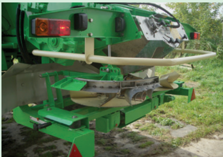
Grenzstreuen incl. Abweiser II hydraulisch fernbetätigt.
