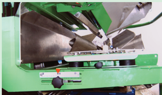
Werkzeuglose Einstellung des Streuwerkes.
