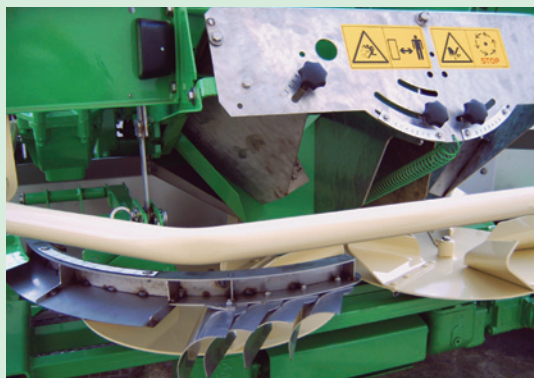
Grenzstreuen incl. Abweiser II eingeschaltet.
