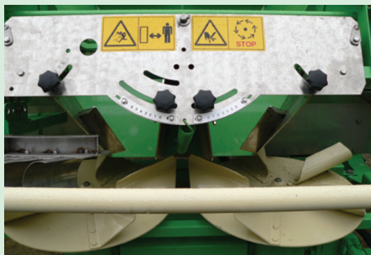
Einstellung des Aufgabepunktes in Querrichtung über Leitbleche.
